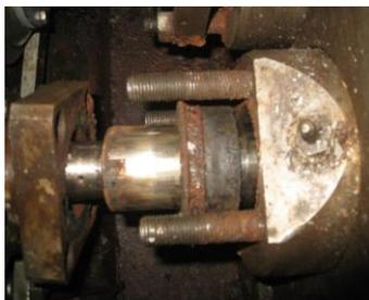
**Рисунок 1.** Узел трения «плунжер-уплотнение» электронасосного дозировочного агрегата. Фланец на грумбуксе снят
